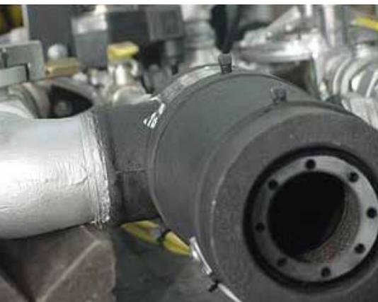
Se construyen íntegramente en fundición de hierro, tanto sus premezcladores gas-aire, como así también sus cabezas de fuego.
