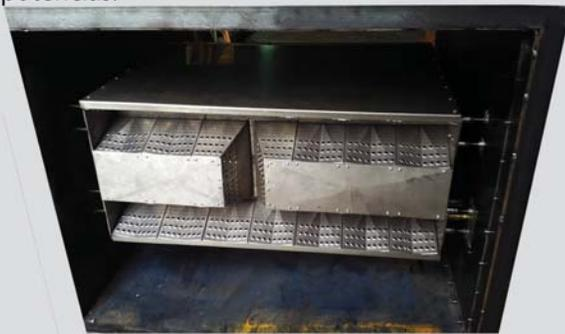
En caso de contar con ductos existentes y ventiladores de proceso existentes, los equipos pueden presentarse provisto de su placa lateral para que simplemente perforando el ducto existente, incorporar la unidad de combustión, quedando todo firmemente anclado a dicha placa, que dejará a la unidad de combustión perfectamente centrado en el ducto existente, sin necesidad de realizar grandes modificaciones.
