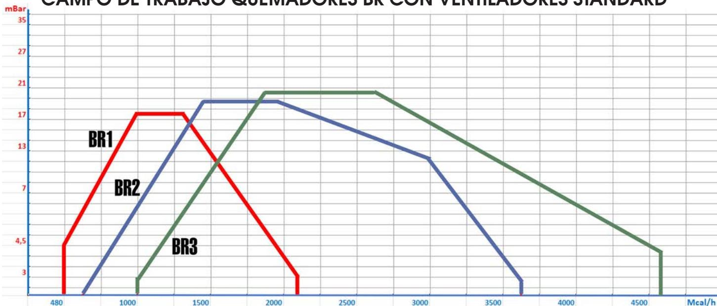
Los quemadores automáticos **Serie BR**, han sido diseñados para trabajar con gas natural, LPG, o cualquier combustible gaseoso, satisfaciendo las necesidades térmicas de aplicación en cámaras de combustión con baja o alta necesidad de presurización, como calderas, hornos, intercambiadores, etc. Mayores contrapresiones son posibles de vencer utilizando las versiones duobloque, con ventiladores separados. *Consulte nuestra oficina técnica.*
